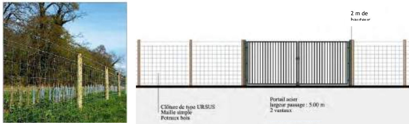
Figure 17 : Illustration du type de clôture préconisé et des portails d'entrée (source : ABO Wind)
